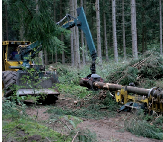
Der Durchzugsentaster ist ein praxisbewährtes Beispiel für Ergonomieverbesserung bei der Langholzaushaltung durch erweiterten Technikeinsatz. Hierzu gibt es auch einen Film: www.svlfg.de , Suchbegriff „Ergonomie durch Technikeinsatz“
