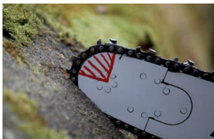
Mit der Unterseite der Schienenspitze ansetzen
