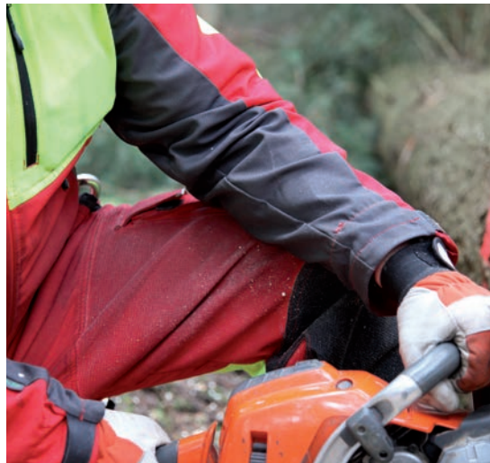
Immer -wenn möglich- Abstützen (hier Unterarm-Oberschenkel beim Einschneiden)
