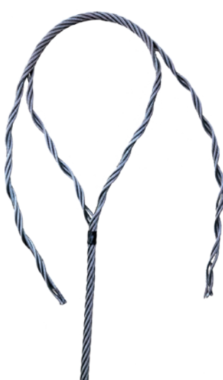
Schleife durch Ineinanderfügen der beiden Litzenverbände bilden.
