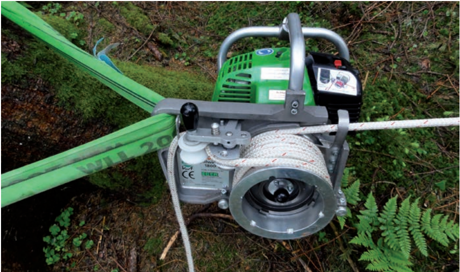
Im Zugkraftbereich bis 1,8 Tonnen kann die Spillseilwinde die motormanuelle Arbeit leichter und sicherer machen.
