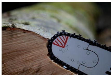
Mit der Schienenunterseite Führungsnut ausformen
