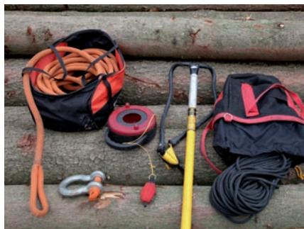
Arbeitsmittel für Anschlaghöhen über 6 Meter (bis ca. 15 Meter): Wurfbeutel, Wurfseil mit Aus-/Aufspulhilfe, Nachziehleine, Wurfbeutelschleuder (Big Shot), Baumzugseil, hier ummanteltes Kunststoffseil, Schäkel, Transportsäcke
