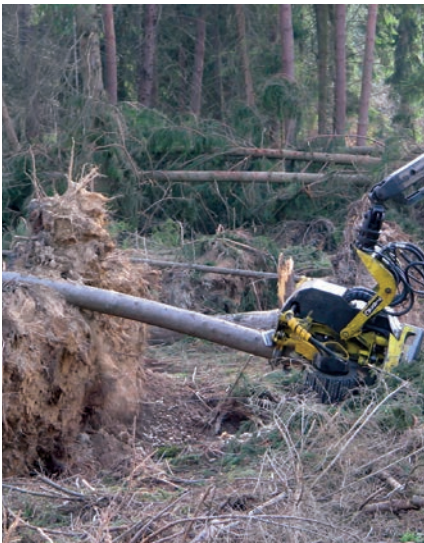
Sichere Spannungsbeseitigung und Abstocken bei der vollmechanisierten Windwurfaufarbeitung
