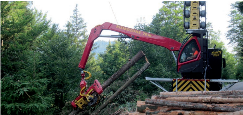
Gebirgscharvester: Auf einem LKW integriertes Seilgerät. Eine anspruchsvolle Technik, die Arbeitsschutz auf hohem Niveau erfordert.
