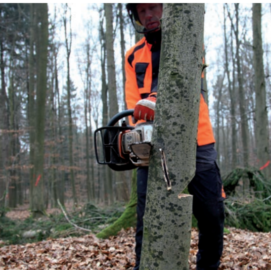
Durchtrennen des Sicherheitsbandes beim diagonalen Stechschnitt
