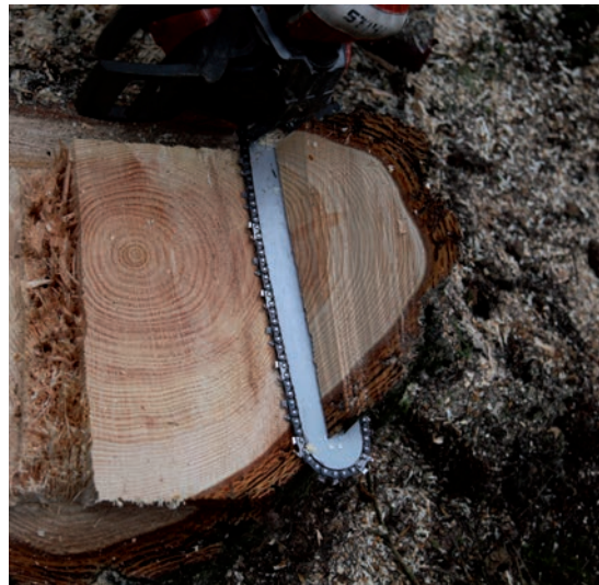
Nach der Fällung Halteband abschneiden
