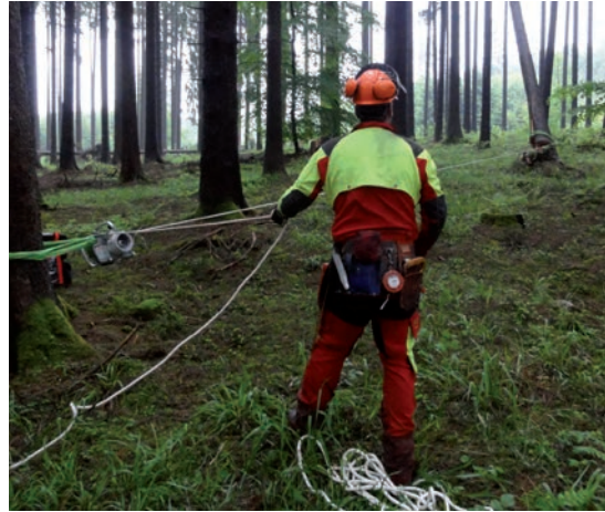
Abziehen mit der Spillwinde
