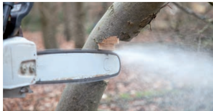
Ausräumen des Druckholzes, der Spannungsabbau zeigt sich im kontrollierten Abknicken
