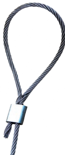
Beilegen der Enden – hier zu einem Seilverband. Vor dem Verpressen der Seilklemme müssen die überstehenden Enden gekürzt werden (1/2 des Seildurchmessers).
