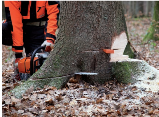
Regelfälltechnik beim seilunterstützten Fällen: Unterschnittenes Sicherheitsband
