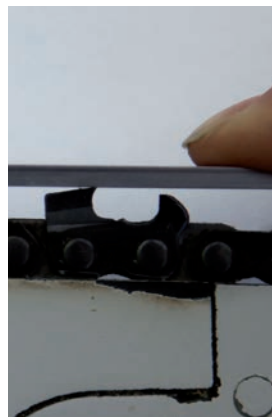
Höhe des Tiefenbegrenzers im Mittel 0,65 mm beachten!
