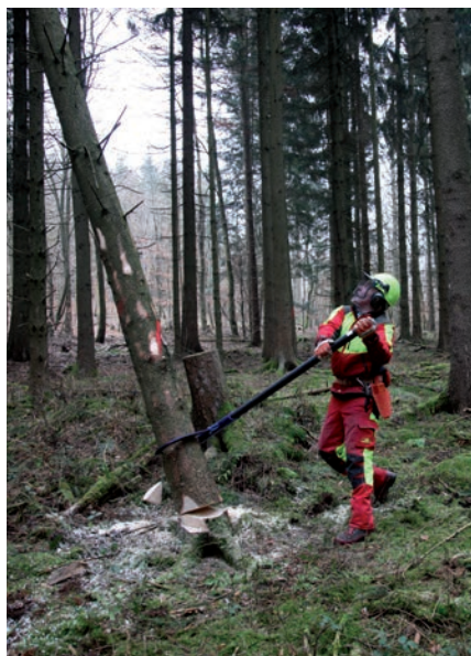
Abdrehen mit dem Wendehaken – immer ziehend arbeiten!
