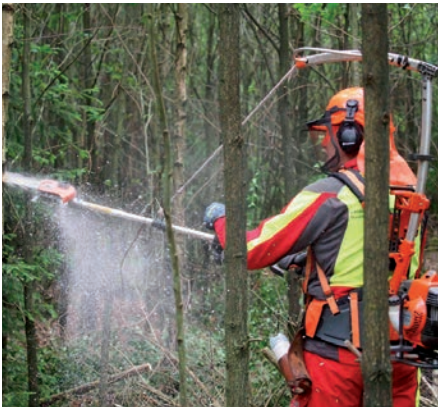
Der sogenannte Spacer ist ein rückertragbarer, ergonomisch bedienbarer Forstfreischneider mit Schneidgarnitur. Die Schneidgarnitur ist an einer Galgenkonstruktion zur Gewichtsentslastung befestigt. Eine Bedienung mit geringster Tragebelastung ist damit möglich, was der ergonomischen und sicheren Steuerung des Arbeitsmittels zugutekommt.
