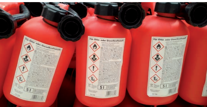
Gefahrstoffbehälter mit entsprechenden Kennzeichnungen
