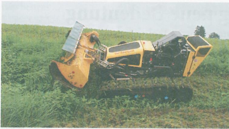
Per Fernbedienung steuert Rolf Triebel (rechtes Bild) das Trägerfahrzeug aus sicherer Entfernung, als ob er auf dem Roboterfahrzeug sitzt. Durch den tiefliegenden Schwerpunkt der Technik kann das Raupenfahrzeug quasi nichts umwerfen. Dadurch sind Arbeiten bis zu einer Hangneigung von 55 Grad möglich.
